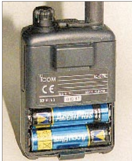
Zwei Mignonzellen genügen zur Stromversorgung.
