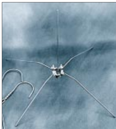
Bild 11: Die Konstruktion von Bild 10 für 70 cm mit Stahldraht von Kleiderbügeln realisiert
