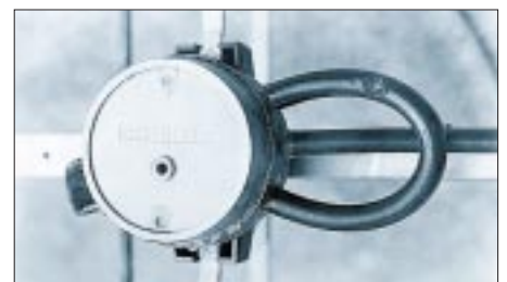
Bild 9: Anpassung/Symmetrierung für 70 cm mit einer Umwegleitung
