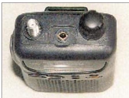
Die Anschlüsse: eine SMA-Buchse und eine vierpolige Klinkenbuchse
