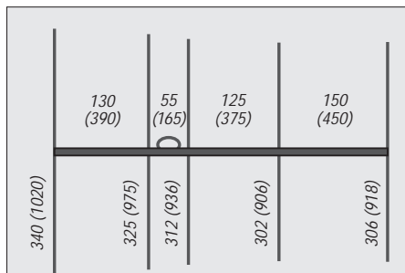
Bild 1: Dimensionierung einer 5-Element-Yagi für das 70-cm-Band (2-m-Band)
