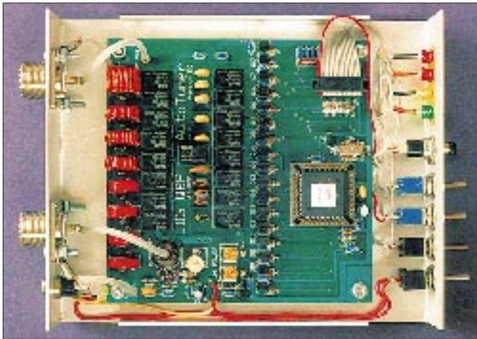
Bild 4: Innenansicht der QRP-Variante V.I.n.r. auf der Leiterplatte die Ringkernspulen, die zugehörigen Relais, die Kondensatoren mit ihren Relais und die Relaisansteuerstufen; rechts der Prozessor. Unten links befindet sich die SWR-Meßschaltung, zwischen den Abstimmkondensatoren das 17. Relais für die high/low-Z-Umschaltung.
