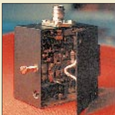
Das Bild zeigt, daß der Sender wirklich winzig ist. Der Deckel läßt sich bequem aufklappen, wodurch die Senderleiterplatte leicht zugänglich bleibt. Foto: OE6ACG
