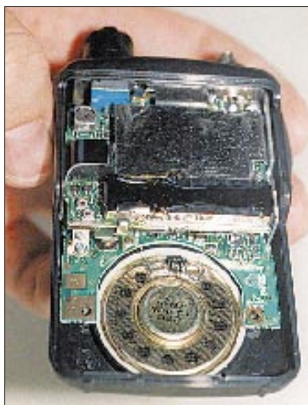
Blick ins Innere: Sandwichartig liegen mehrere gut abgeschirmte Leiterplatten übereinander. Links oberhalb des Lautsprechers befindet sich die Spule des Spannungswandlers. Der Lautsprecher selbst zehrt vom Restvolumen und liefert dadurch einen guten Klang. Fotos: Autor
