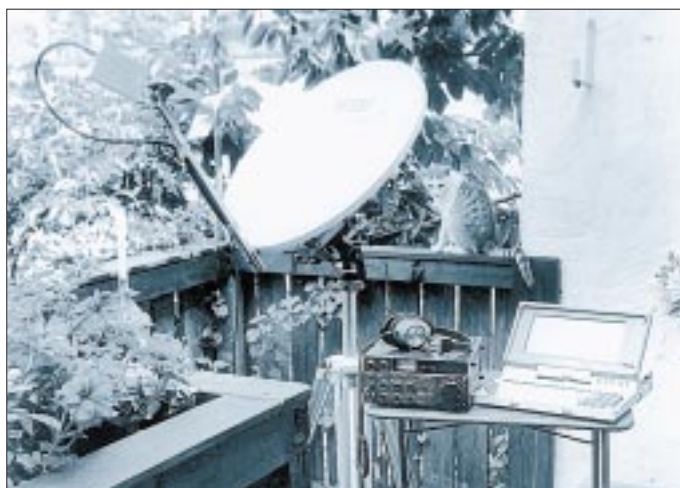
Bild 13: Versuchsaufbau zum Empfang der OSCAR-13-Bake auf 2400,664 MHz
