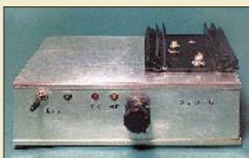
Der Transverter wurde zusammen mit einem zweistufigen Linearverstärker in einer Weißblechbox untergebracht. Foto: DJ9FG
