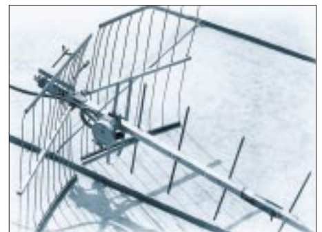
Bild 8: 70-cm-Yagi unter Verwendung von Eck- und Flächenreflektoren aus UHF-TV-Antennen für ein höheres Vor-/Rück-Verhältnis
